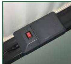
**Particolare 4:** Interruttore ON/OFF con alimentazione a batterie, ricaricabili grazie al pannello solare posto sopra l'ombrellone, + alimentazione a 220V.
